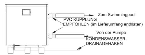
Kondensation: Da die Wärmepumpe die Luft um ca.  $4-5\,^{\circ}$ C abkühlt, kann Wasser auf den Lamellen des hufeisenförmigen Verdampfers kondensieren. Falls die Luftfeuchtigkeit sehr hoch ist, können etliche Liter Wasser pro Stunde anfallen. Das Wasser läuft von den Lamellen in die Bodenwanne, von wo aus es durch den sich auf der Seite der Bodenwanne befindlichen Kondenswasser-Drainagehaken abläuft.
